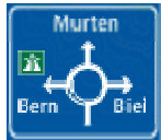
Vorwegweiser bei Kreisverkehrsplatz
